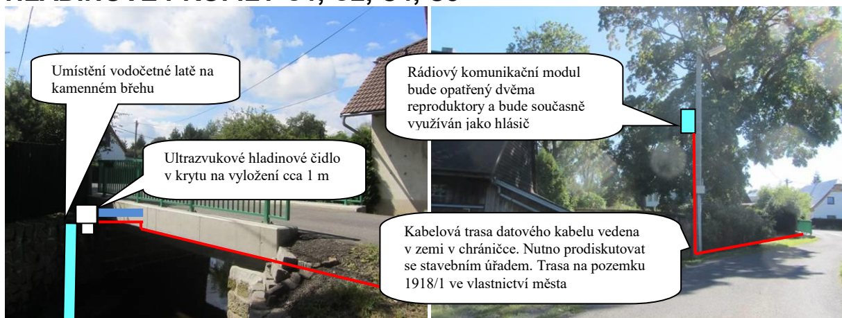
Obr. 1 Most Strážný, Potoční – umístění čidla HP
