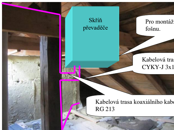
Obr. 1 Půda – umístění skříně
